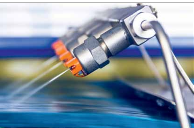
Abb. 2: Einsatz von Chlordioxid bei der Reinigung von Förderbändern.
