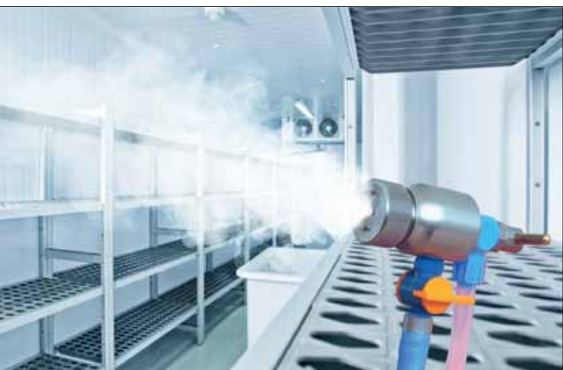
Abb. 1: Ausbringen von Chlordioxidlösung als feiner Nebel zur Raumdesinfektion.
