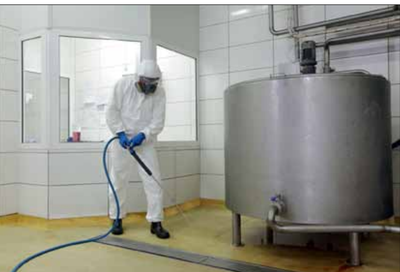
Abb. 3: Manuelles Ausbringen einer DK-DOX®Chlordioxidlösung mittels Sprühlanze.
