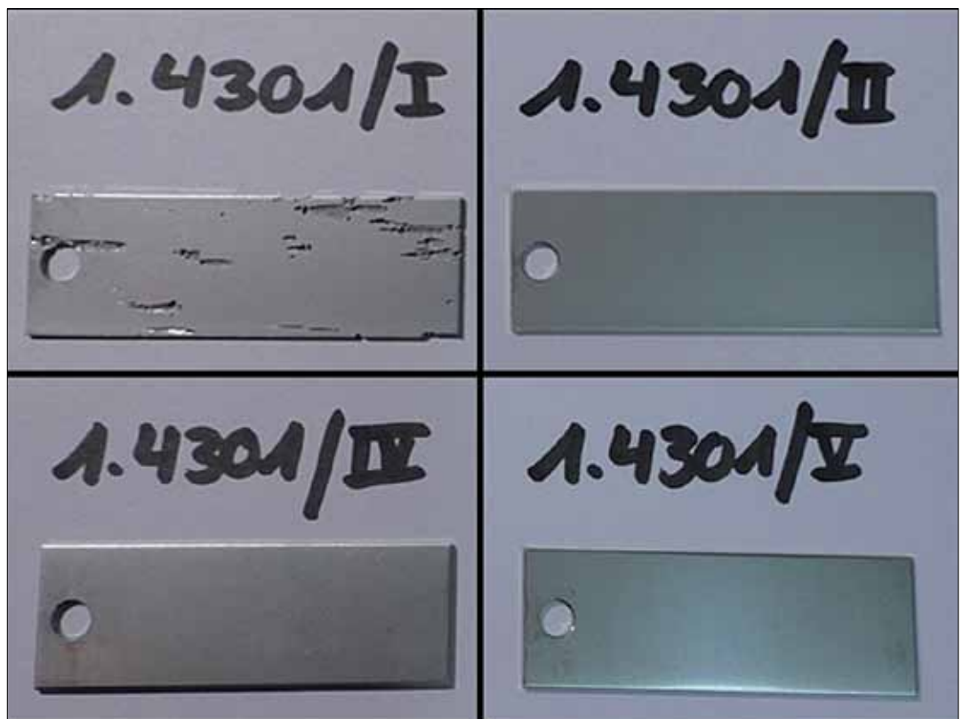
Abb. 2: Prüfkörper I/IV (salzsaurer Chlordioxidlösung) und II/IV (pH-neutrale DK-DOX® Chlordioxidlösung) nach 120 Stunden Einwirkzeit in Chlordioxidlösung ~1000 ppm/-50 ppm.
