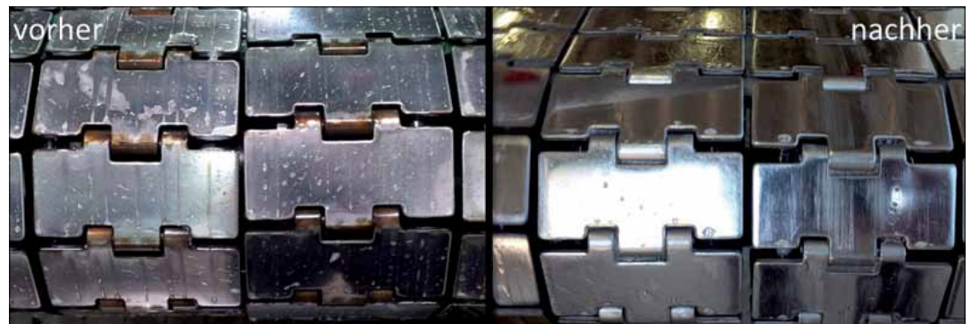
Abb. 3: Transportbänder in einer Brauerei. Zu sehen ist das Band vor dem Beginn der Zugabe von DK DOX® („vorher“, links) und im Betrieb mit DK DOX® („nachher“, rechts).
